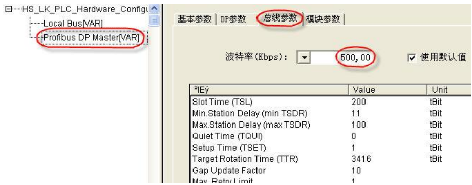
图 43 DP 总线主站参数设置(总线参数)
