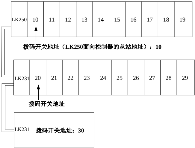
图 275 级联扩展背板的拨码开关设置
